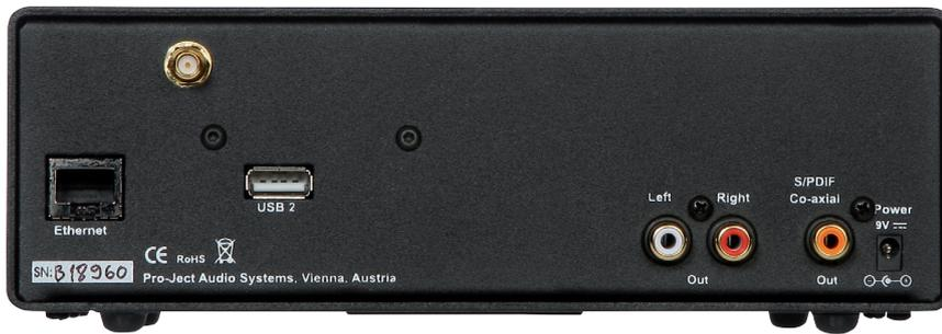
**FULL METAL JACKET:** Der dicke, umlaufende Gehäusemantel macht den Pro-Ject stabil wie eine Geldkassette. Ethernet, WLAN und USB sitzen links, die Ausgänge rechts.
